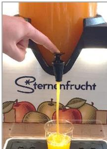
**Ausrichtung 2:** Wird der Ausgabehahn runtergedrückt, erfolgt der Getränkeausschank, bis der Hahn wieder losgelassen wird.
